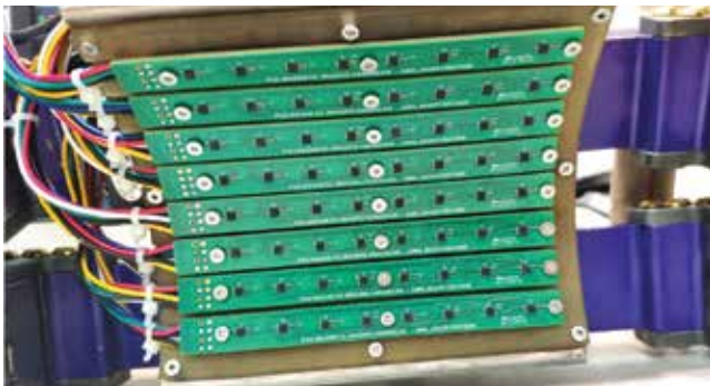
Hình 14. Ảnh chụp mảng cảm biến đã được gắn vào guốc cong (chưa che lớp bảo vệ).
